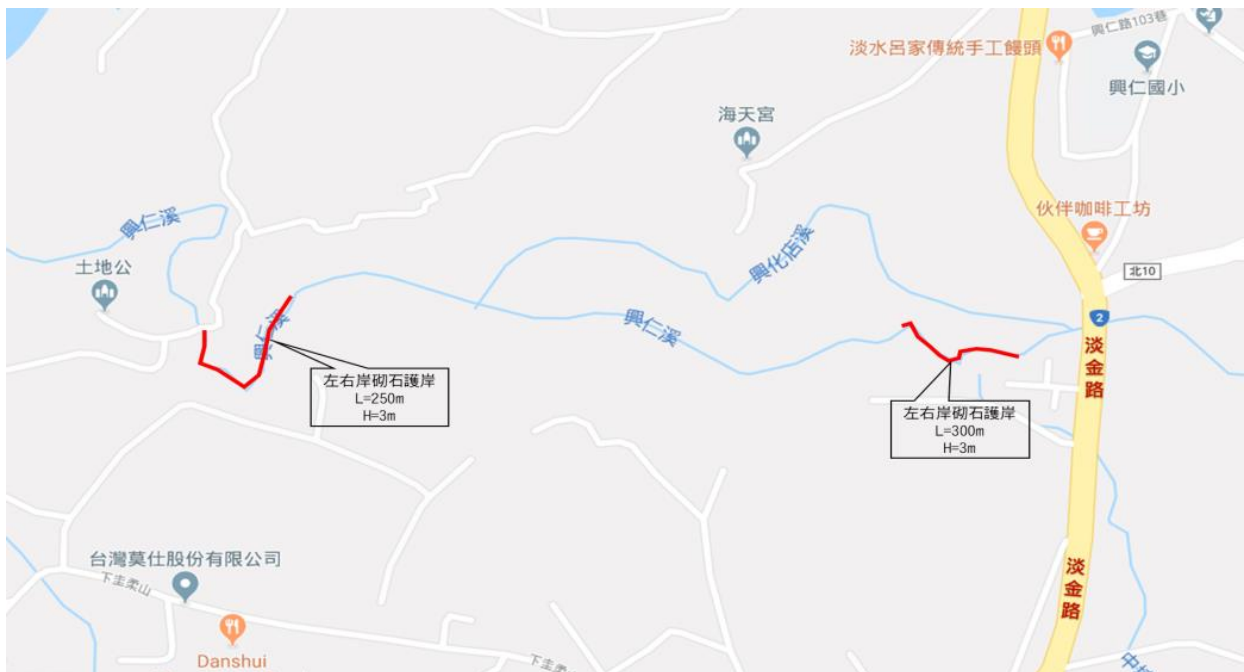
淡水區興仁溪淡金公路下游至出河口段護岸應急工程
